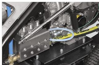
Pompe TW Premium 700 avec tête en laiton nickelé et pistons « FULL » céramique
